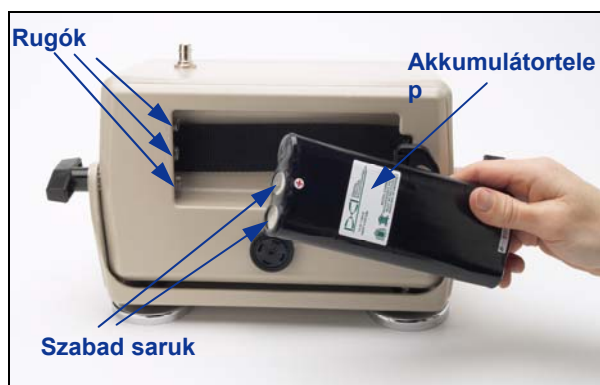
Akkumulátor elhelyezése a távvezérelt kijelzőben
