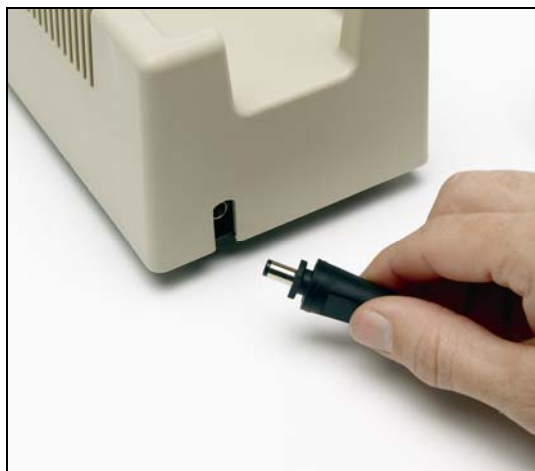
Установка штекера зарядного устройства в разъем электропитания
