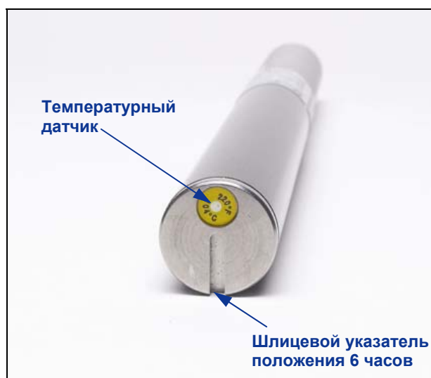
Передняя крышка зонда с температурным датчиком и шлицевым указателем
