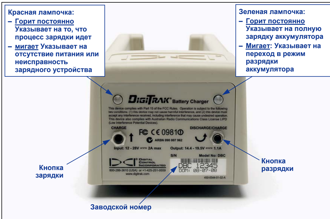
Панель управления зарядного устройства
