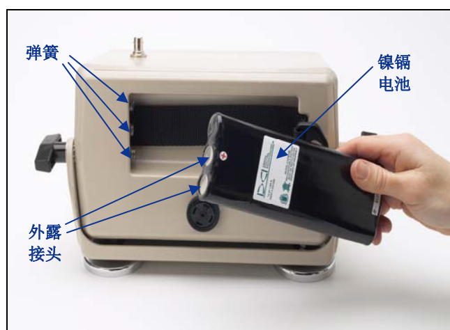
安装远程显示器电池
