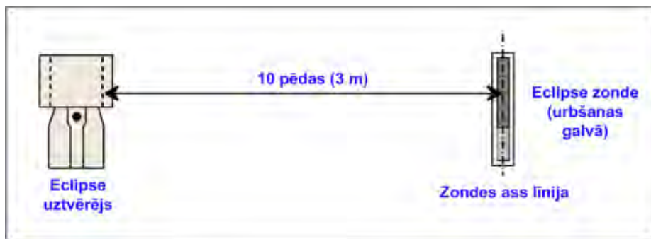
3 m (10 pēdu ) attāluma mērīšana kalibrēšanai pēc viena punkta
