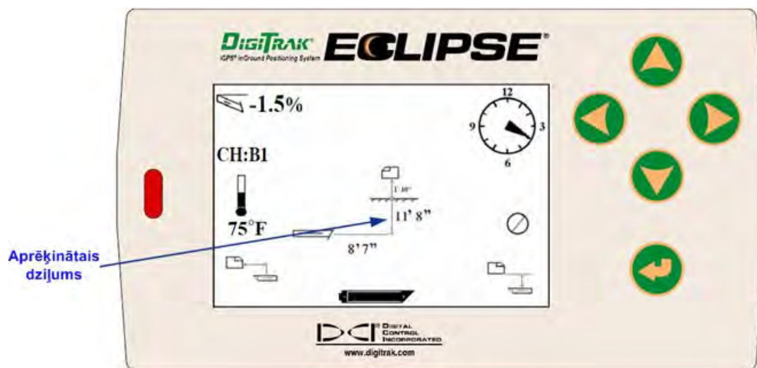
Distances displeja ekrāns ar aprēķinātā dziļuma rādījumu (uztvērējs atrodas virs lokācijas punkta FLP un RLP)
